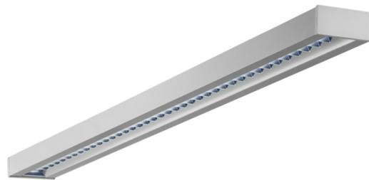
LED-Deckenleuchte, Serie ZOLA, direkt und direkt/indirekt strahlend. Gehäuse aus Aluminium, weiß, pulverbeschichtet. Diffusor Parabolraster, matt. Betriebsgerät schaltbar oder DALI dimmbar, integriert. UGR < 16 und Bildschirmgerecht gemäß EN 12464-1. Ausführung mit Casambi Bluetooth Steuerung verfügbar. DC tauglich.
