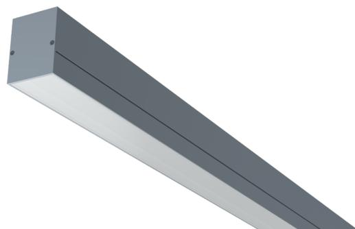
LED-Decken- und Wandleuchte, Serie MAVS. Gehäuse aus Aluminium, weiß, pulverbeschichtet. Diffusor Kunststoff (PMMA) opal, UV-stabilisiert. Betriebsgerät schaltbar oder DALI dimmbar, integriert. Ausführung mit Casambi Bluetooth Steuerung verfügbar. DC tauglich.
