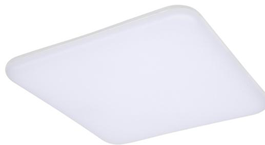
Luminaire LED mural et plafonnier, série LARIO, IP54. Boîtier et diffuseur en PC (résistant au feu et aux UV), opale. Module de commande commutable intégré. Trois niveaux de réglage de la température de couleur (3000 K, 4000 K, 5700 K) via interrupteur DIP. Modèle disponible avec commande Bluetooth CASAMBI.
