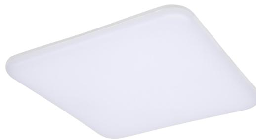
LED-Decken- und Wandleuchte, Serie LARIO, IP54. Gehäuse und Diffusor aus PC (feuer- und UV beständig), opal. Betriebsgerät schaltbar, integriert. Dreistufige Einstellung der Farbtemperatur (3000K, 4000K, 5700K) über DIP Schalter. Ausführung mit Casambi Bluetooth Steuerung verfügbar.
