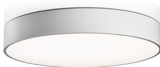
LED-Decken- und Wandleuchte, Serie HUGO, als grundlegende Lichtausstattung für Geschäfts- und Wohnräume. Gehäuse aus Aluminium, weiß, pulverbeschichtet. Diffusor Kunststoff (PMMA) opal, UV-stabilisiert. Betriebsgerät schaltbar oder DALI dimmbar, integriert. Ausführung mit Casambi Bluetooth Steuerung verfügbar. DC tauglich.
