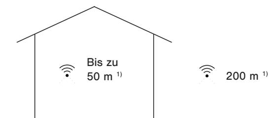
Casambi verwendet die Mesh-Netzwerktechnologie, so dass jeder CBU-TED-LR auch als Repeater fungiert. Größere Reichweiten lassen sich durch Einsatz mehrerer Casambi-Einheiten erreichen.
